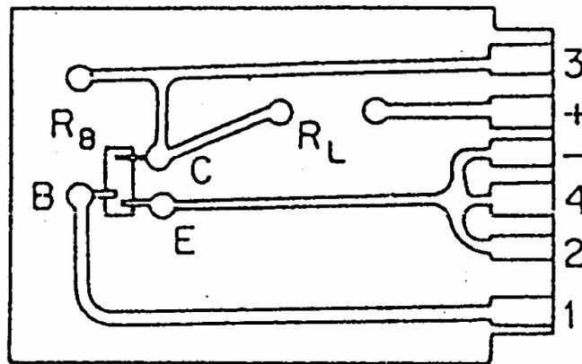
**Fig. 1-b: Conductor Pattern**
